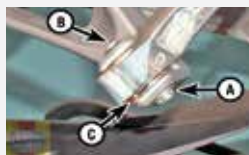
3.1b Pasador dividido y arandela (A), pivote (B), placa de retención, bola y resorte (C) - reposapiés para pasajeros
