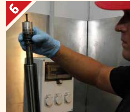
Montamos en las botellas y barras originales los nuevos componentes de YSS, que encajarán al dedillo, y atornillamos por el tornillo inferior de fijación.
