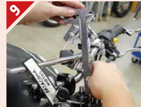
Una vez cerradas las botellas, volvemos a montar las horquillas en la moto respetando la distancia del offset superior. Presentamos apretando levemente el tornillo de sujeción superior.
