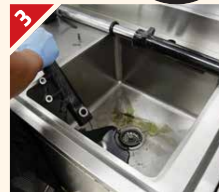
Pasamos a trabajar sobre el banco. Tras liberar los retenes de horquilla, aflojamos el tornillo inferior para vaciar el aceite original. ¡Está hecho trizas!
