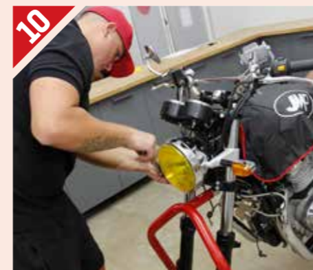
Reapretamos los tornillos de las pletinas de la tija, pero ¡cuidado! Si nos pasamos de fuerza, podemos deformar las botellas y comprometer su función.
