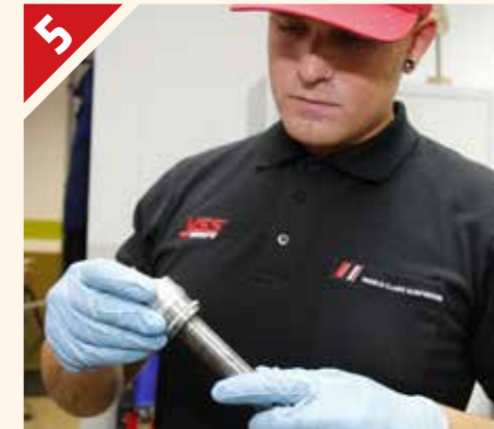
Para encajar el nuevo pistón YSS en el vástago, puede que necesitemos la ayuda extra de una prensa, pero en general encaja a la primera sin esfuerzos.
