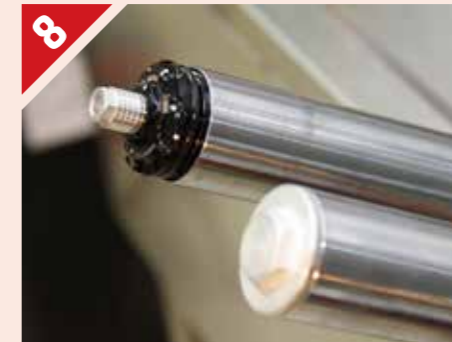
Cerramos la barra con la nueva cubierta superior que incluye el tornillo regulador de la compresión. ¡Ya hemos ganado una funcionalidad clave que marcará una crucial diferencia con la original!
