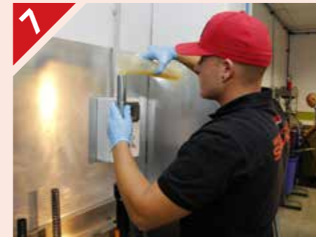
Rellenamos la botella con el aceite que acompaña el kit YSS (250 ml. de 15 W) y bombeamos para evitar dejar aire dentro. En el caso de la Interceptor, necesitaremos algo más de 450 ml de aceite para ambas botellas. ¡Importante tenerlo en cuenta!
