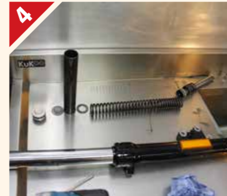
Extraemos los componentes originales: pistón, vástago, muelle principal, resorte, tope y cubierta superior del cartucho.
