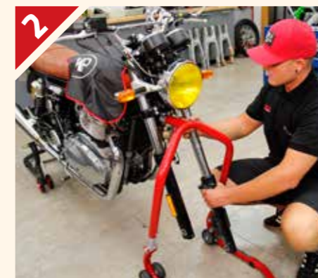
Con la rueda delantera fuera y todos los tornillos de las pletinas de la tija que sujetan las barras sueltas, extraemos ambas horquillas para vaciarlas.
